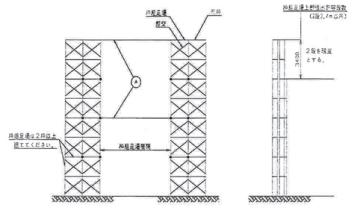
壁つなぎ間隔 枠組足場2段(3.4m)毎 壁つなぎ許容強度 耐力450kg(仮設工業会認定品を使用して下さい。)
