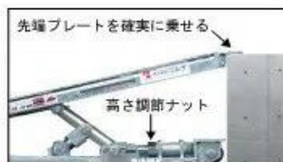
⑥ 高さ調節ナットは段差側に回して隙間なく締める。
