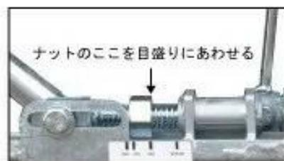
⑤ 段差を段差に寄せて、少し天板を持ち上げ安全ストッパーを外して倒し、段差に先端プレート確実に乗せ、高さ調節ナットで高さの微調整をする。
